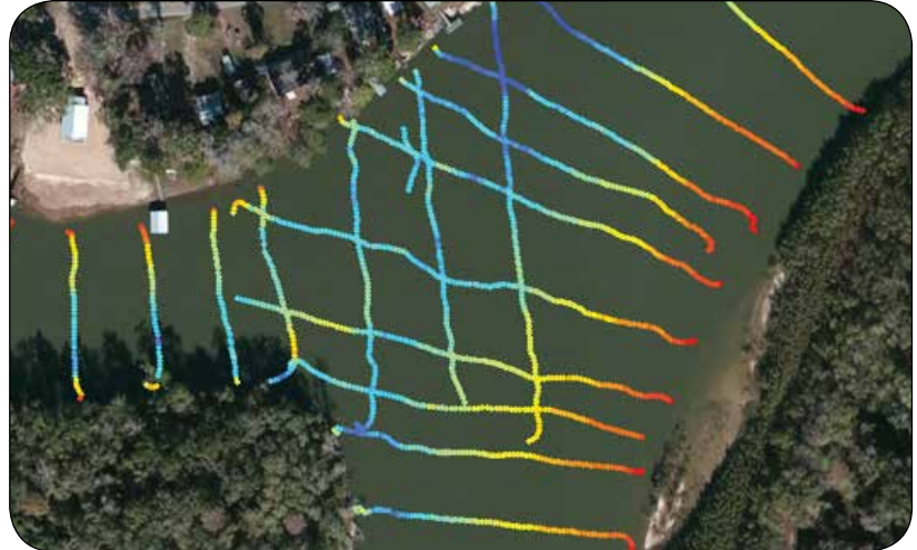
Imagen Batimétrica utilizando ecosonda de haz simple. Imagen proporcionada por CBEC Engineering, Inc.
